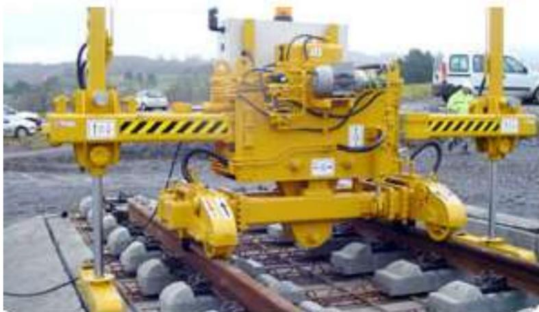
Figura 5. Pórtico de nivelación
