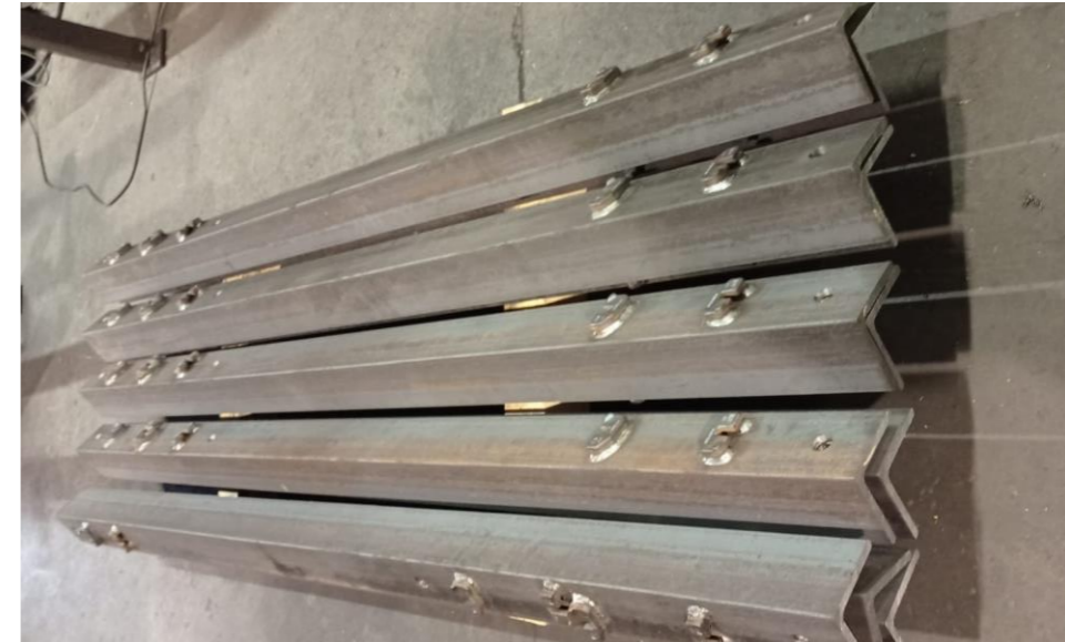
Figura 9. Perfil metálico (montaje vía estuchada)
